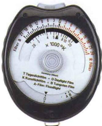
Stariji kelvinometar jednostavnije konstrukcije ( Gossen Sixtycolor ).
