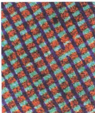
Povećana snimka presjeka Dufaycolor filma, na kojoj je vidljiv mozaični raster plavih, crvenih i zelenih linija.
